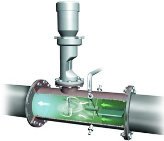
Сл. 58: Пример изгледа једног "in-line" миксера коагуланта (произвођача Walker Process Equipment)
