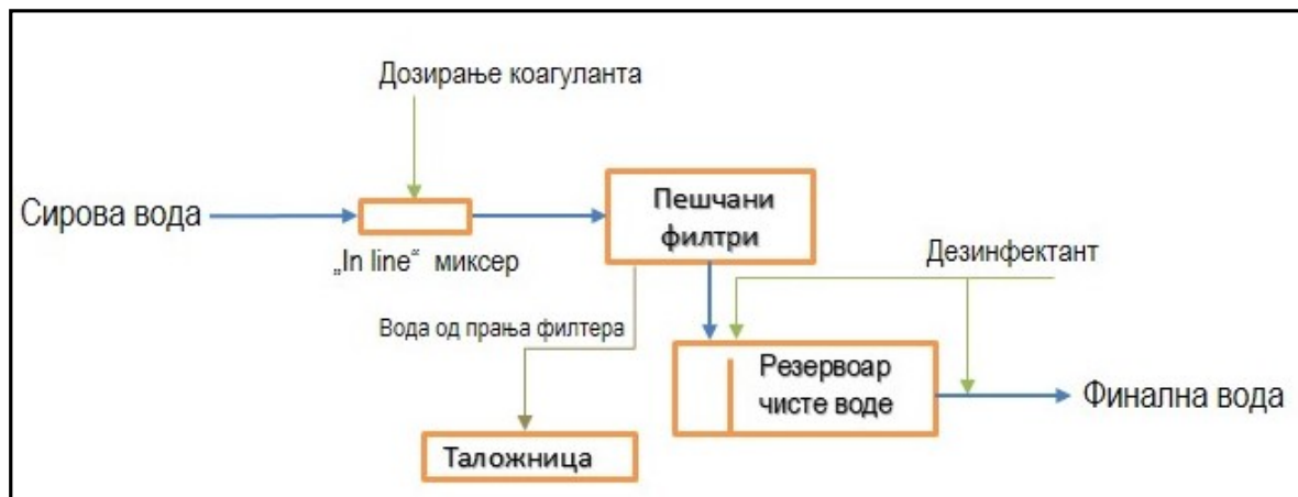
Сл. 57: Блок шема предложеног третмана воде
